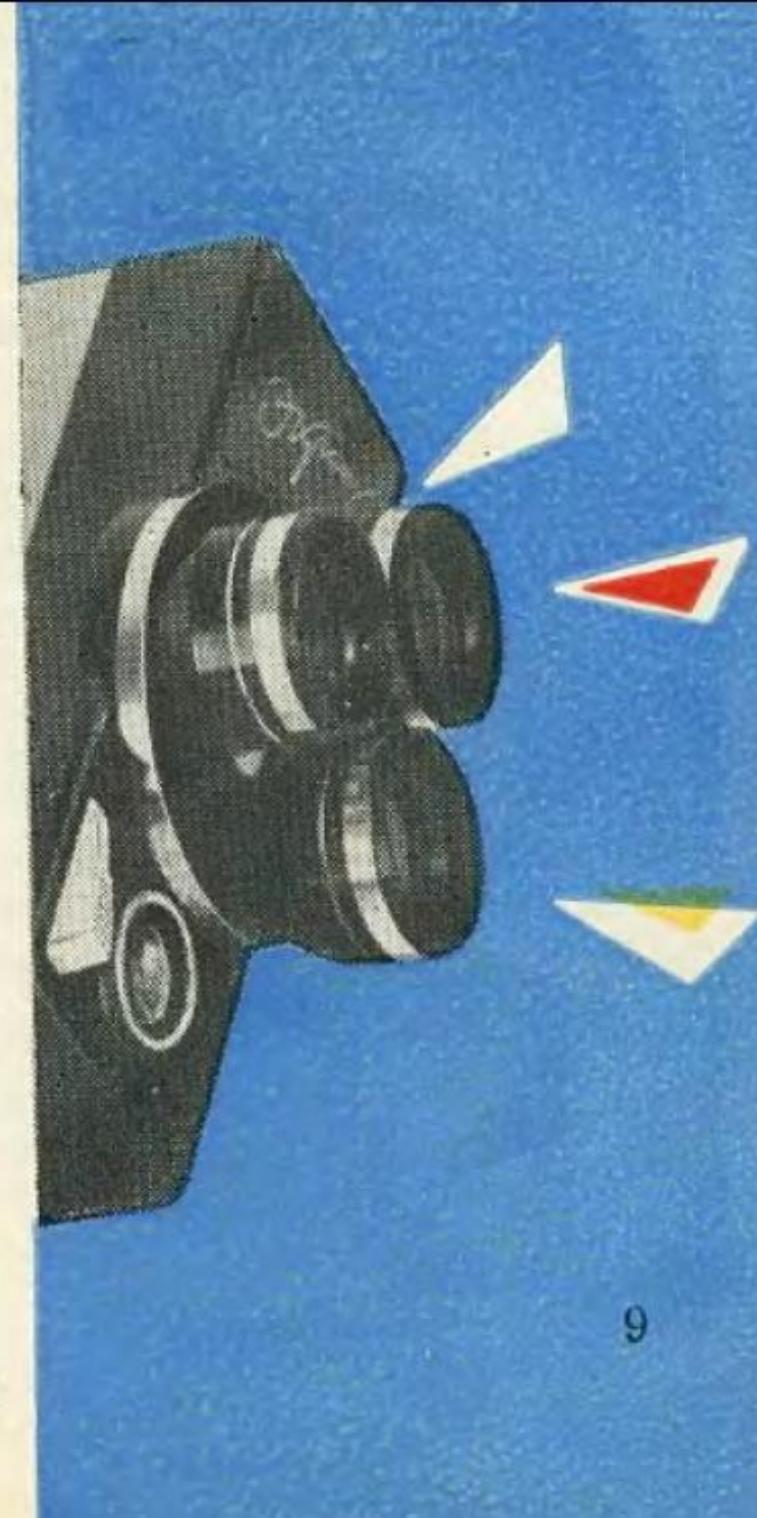
Телескопическую насадку  $0,5^x$  (широкоугольную) целесообразно применять для панорамных съемок, для охвата большого пространства:
