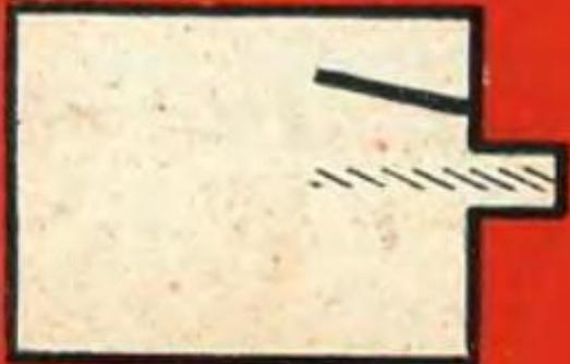
В рамке визира видна стрелка гальванометра, по которой определяется правильность выбора экспозиции, и шкала величины относительных отверстий объектива.
