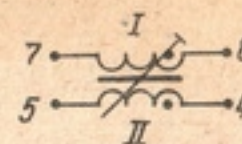
Схема электрическая принципиальная трансформатора
