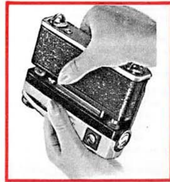
Рис. 5. Снятие задней стенки
