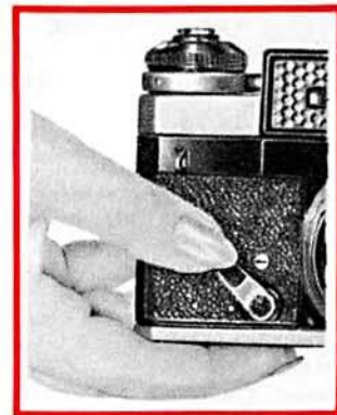
Рис. 17. Взвод рычага автоспуска
