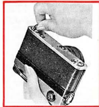
Рис. 4. Открывание замков на задней стенке
