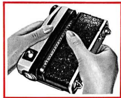
Рис. 11. Закрывание задней стенки
