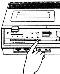
При необходимости пропустить часть записываемой программы нажмите кнопку ⏸. Для продолжения записи повторно нажмите эту же кнопку. При длительности паузы более 6 минут видеоманитфон автоматически выключается в целях предохранения видеоленты и видеоголовок от преждевременного стирания. Для исключения нежелательных перерывов между записями на ленте выполните следующее:
